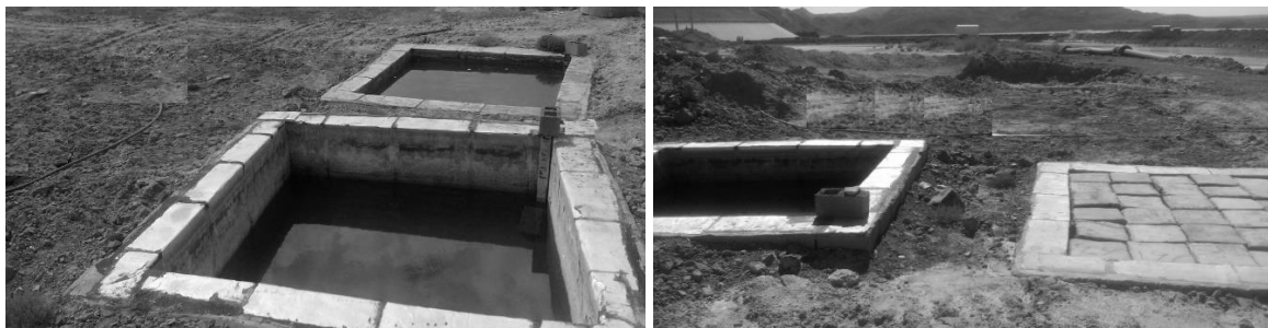
شکل ۸- استفاده از پوشش یورتالات در حین اندازه‌گیری و بعد از اتمام پروژه و برداشتن پوشش‌ها
