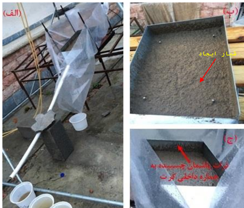
شکل ۱- الف) نمایی از کورت مورد استفاده در پژوهش، شرایط آزمایشگاهی و اندازه‌گیری رواناب و رسوب، ب) نمونه‌ای از شیاریهای ایجاد شده در بخش مرکزی و نیمه پایینی سطح کورت، ج) نمایی از ذرات پاشمان چسبیده به جداره داخلی کورت
