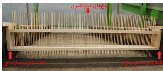
شکل ۴- نمایی از شیارسنج استفاده شده در پژوهش حاضر
