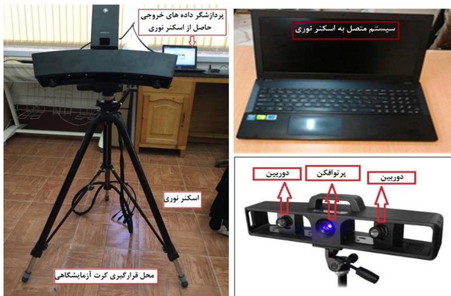
شکل ۲- نمایی از دستگاه اسکن نوری مدل Opticscan-DS مورد استفاده در پژوهش حاضر
