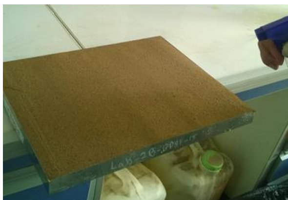
شکل ۳- مالچ‌پاشی نمونه با پلیمر
