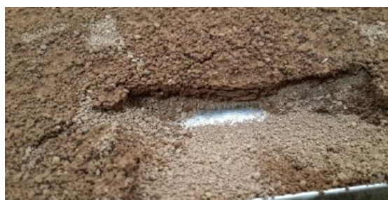
شکل ۶- نمایی از عمق نفوذ تثبیت‌کننده‌ها در خاک
