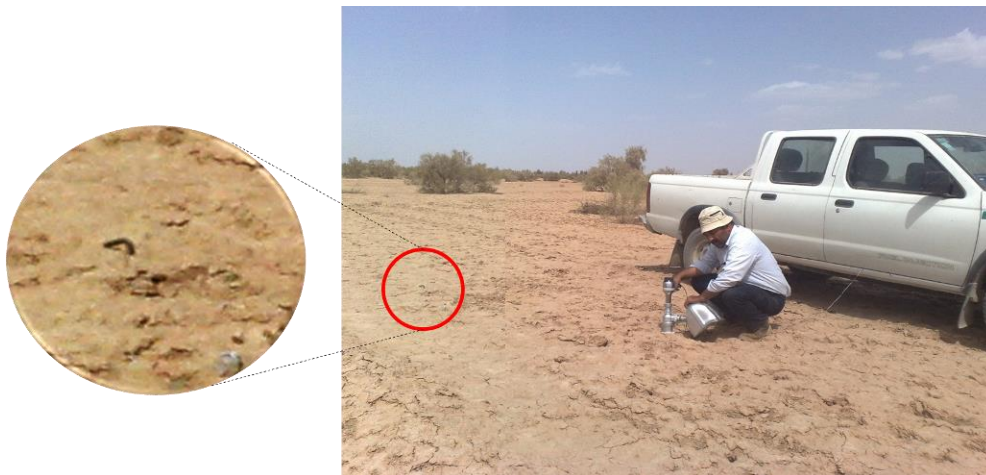
شکل ۶- استفاده از دستگاه برای اندازه‌گیری فرسایش‌پذیری خاک به باد در عملیات صحرایی (تصویر سمت چپ نمای بزرگ شده از شاخص نصب شده برای سنجش میزان بادبردگی خاک برای ارزیابی دستگاه را نشان می‌دهد)
