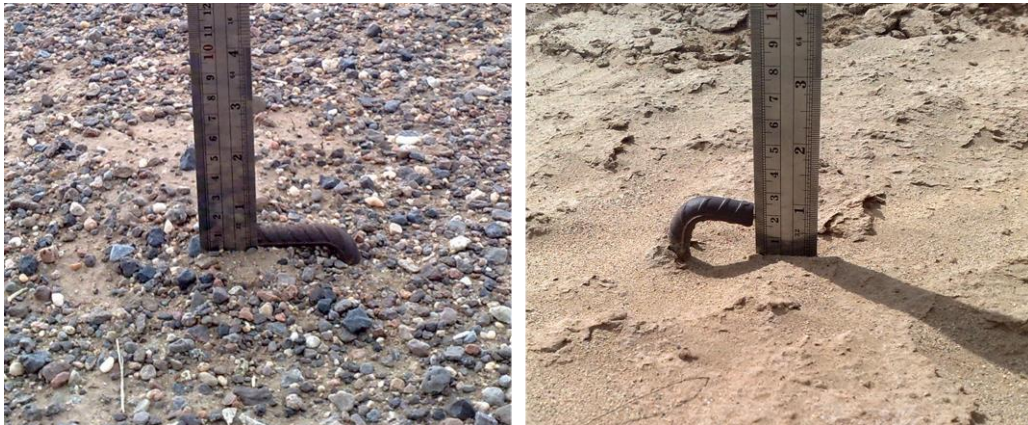
شکل ۷- اندازه‌گیری ارتفاع بادبردگی خاک از زیر شاخص‌های فلزی در اراضی مختلف منطقه مورد بررسی
