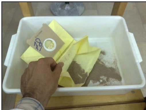
شکل ۸- ذخیره ذرات فرسایش‌پذیر در درون فیلتر کیسه‌ای مخزن دستگاه
