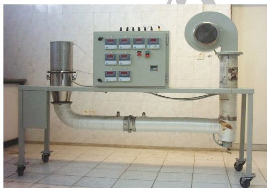
شکل ۱- خشک کن بستر سیال مورد استفاده در آزمایش
