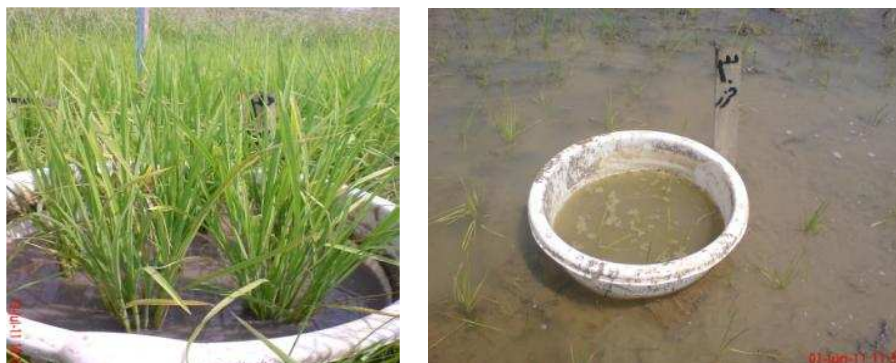
شکل ۱- مینی لایسیمتر استوانه‌ای جهت اندازه‌گیری تبخیر-تعرق برنج.
