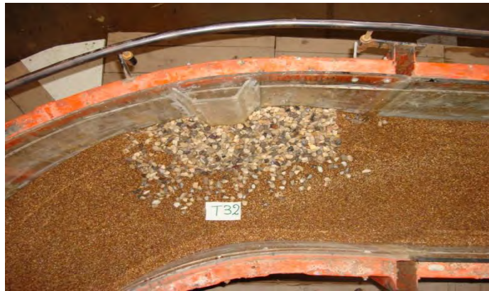
شکل ۳- آستانه شکست سنگچین در نمونه‌ای از آزمایشات
