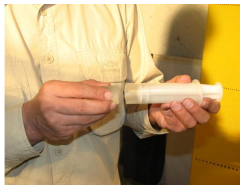
شکل (۱۱): سرنگ جهت مغزه‌گیری از بستر
