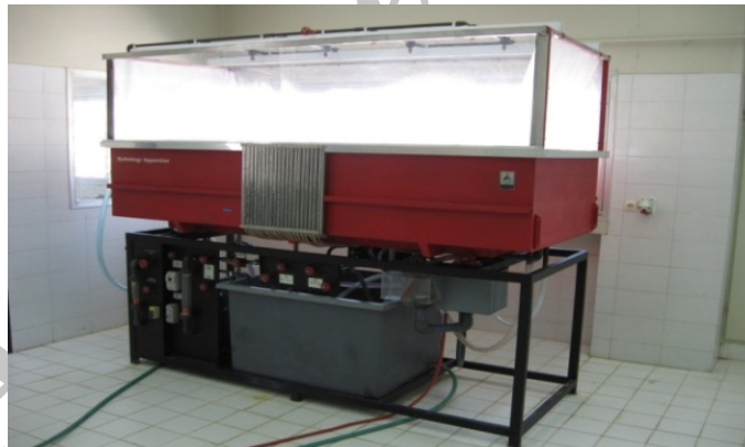
شکل(۱): نمای کلی از مدل فیزیکی زهکش زیرزمینی
