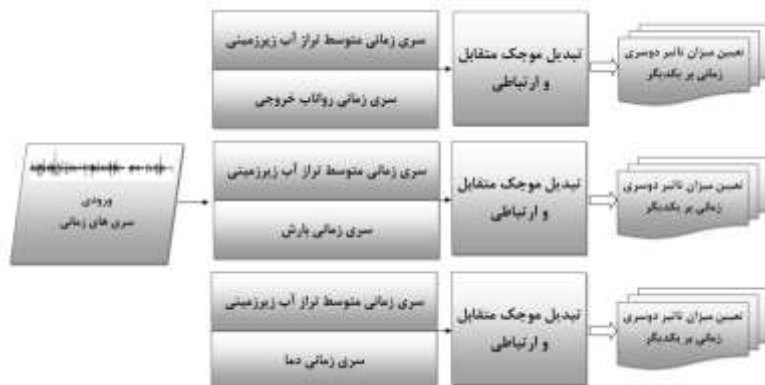
شکل (۵): روند تعیین میزان تاثیر سری‌های زمانی رواناب، بارش و دما بر روی تغییرات تراز آب زیرزمینی دشت
