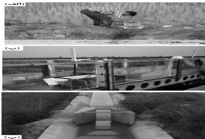
شکل ۳-پیش و اندازه‌گیری در کانال: الف) استفاده از فلوم RBC برای جریان تحویلی به کرت‌ها، ب) کالیبراسیون فلوم RBC، پ) استفاده از پارشال فلوم برای اندازه‌گیری جریان تحویلی به کانال
