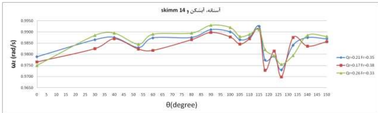
شکل ۱۱ - تغییرات مقدار چرخش جریان در طول قوس ۱۸۰ برای آزمایش آستانه، آبشکن و دیوار جداکننده ۱۴ درجه
