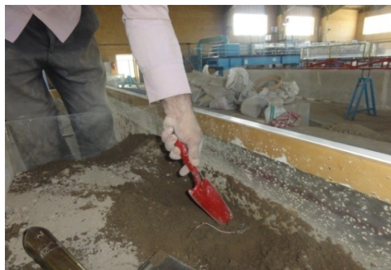
شکل ۲- نمایی از نقاط اندازه‌گیری نیترات در هر محفظه و نمایی از نمونه‌برداری خاک در نقاط مشخص شده پس از انجام آزمایش.
