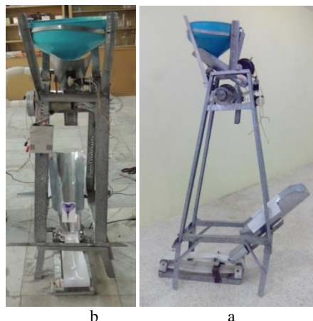
شکل ۵- (a) محل قرار گرفتن سطح شیب دار و (b) نحوه ردیف سازی گل بر روی نقاله
