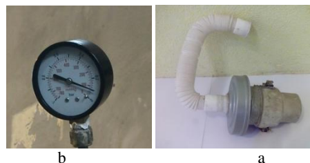
شکل ۳- a) فن مکش و b) فشارسنج Figure 3- a) Suction fan and b) Vacuum gauge.
