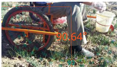
ب) زاویه پا در وضعیت معمول برای چیدن گل (مرحله وسط در حرکت رو به جلو) b) Leg angle while picking flowers (middle step of moving forward).
