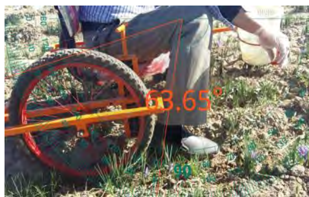
ج) زاویه پا در وضعیت جمع شده (آخرین مرحله حرکت رو به جلو) c) Leg angle with backward position (the last stage of moving forward).
