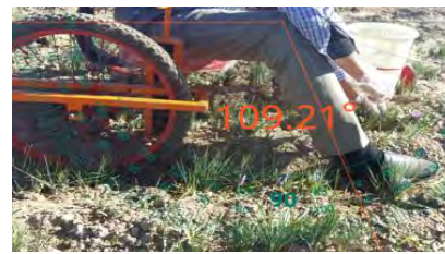
الف) زاویه پا در وضعیت کشیده (اولین مرحله در حرکت رو به جلو) a) Leg angle with stretched position (the first step of moving forward).
