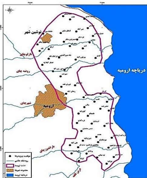
شکل ۳. موقعیت چاه‌های مشاهده‌ای در دشت ارومیه
