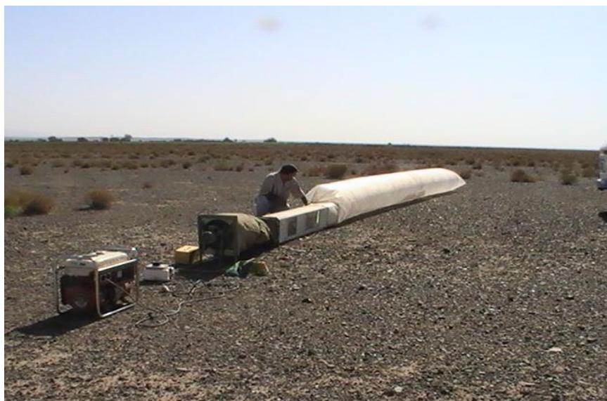
شکل ۳- دستگاه سنجش فرسایش بادی مورد استفاده در منطقه
