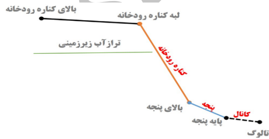
شکل ۳. تعیین نقاط ایستگاهی برای نیمی از مقطع عرضی مدل BSTEM
