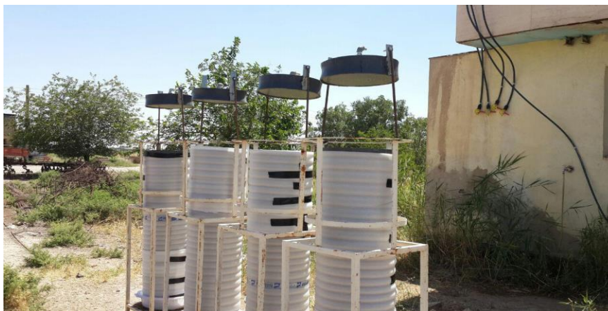
شکل ۱. لایسیمترها و شبیه‌ساز بارش استفاده شده در آزمایش
