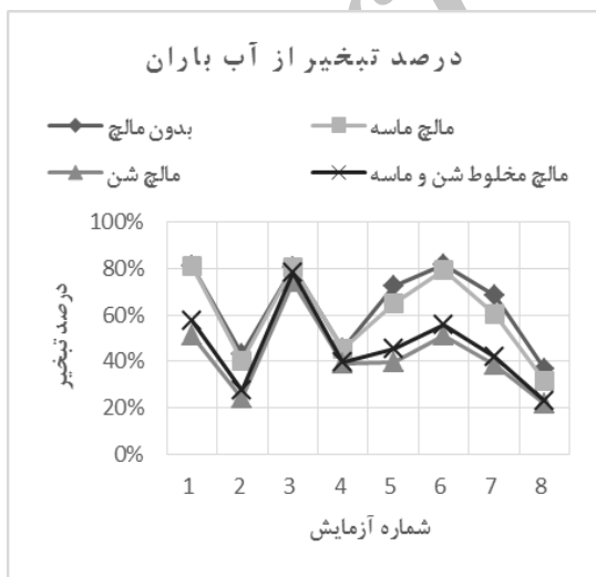
شکل ۴. عمق بارش به همراه درصد افزایش رطوبت خاک، تبخیر و نفوذ عمقی آب باران در هر آزمایش به تفکیک نوع مالچ
