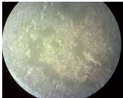
شکل (۳): بلورهای نمک تشکیل شده در ته ظرف پس از خروج محلول صاف‌شده گردوغبار از آون
