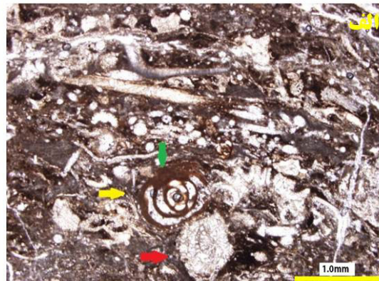
شکل ۸. الف) تصویر میکروسکوپی ریزرخساره وکستون/پکستون بایوکلاستی، خانواده همی‌گوردیوپسیده (فلش زرد)، خانواده استافلییده (فلش قرمز)، فرایند میکرایتی شدن (فلش سبز) مشاهده می‌شود، نور ppl. ب) تصویر میکروسکوپی ریزرخساره وکستون بایوکلاستی جلبکی، نور ppl.
