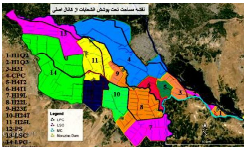
شکل ۲. محدوده‌های تحت پوشش انشعابات درجه دو از ساحل چپ کانال اصلی
