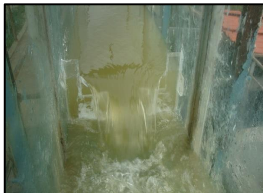
شکل ۴- نمایی از جریان ریزشی در سرریز-دریچه مرکب نصب شده در فلوم آزمایشگاهی
