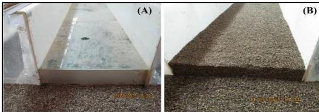
شکل ۳- اختلاف تراز در (A) بستر فرسایش ناپذیر (B) بستر فرسایش‌پذیر
