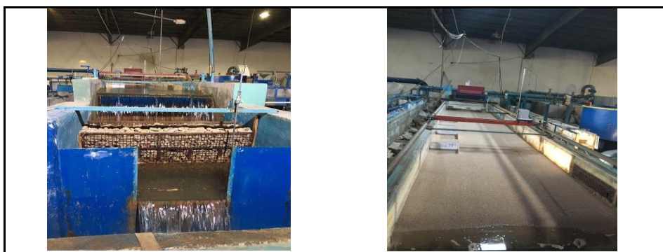
شکل ۳- کانال آزمایش و سرریز مستطیلی کانال
