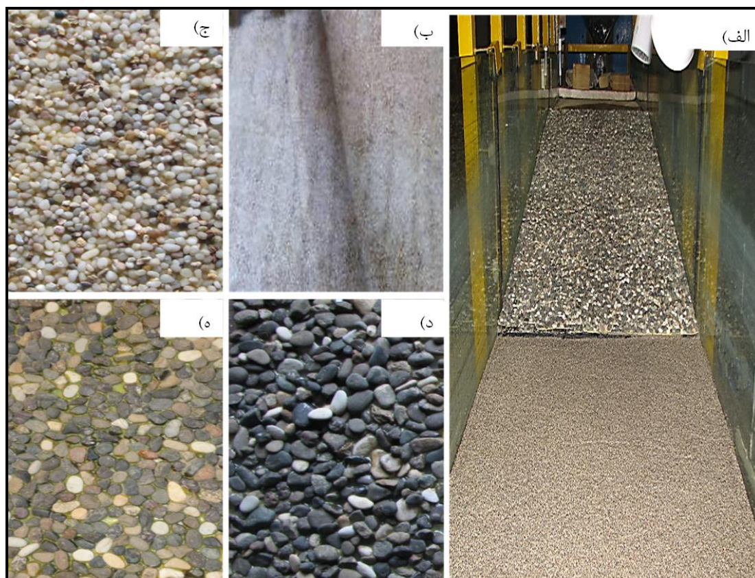
شکل ۳- تصاویری از سازه کنترل تراز بستر سطح شیب‌دار و زبری‌های مختلف مورد مطالعه الف) نمایی از بستر رسوبی و سطح شیب‌دار پس از نصب زبری، ب) بدون زبری با قطر ۴ میلی‌متر، ج) زبری با قطر ۴ میلی‌متر، د) زبری با قطر ۷/۳ میلی‌متر و ه) زبری با قطر ۱۰ میلی‌متر
