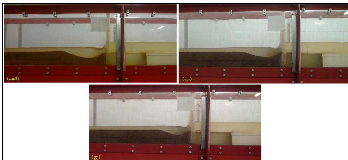
شکل ۱۰- نمایی از پروفیل طولی آبشستگی
