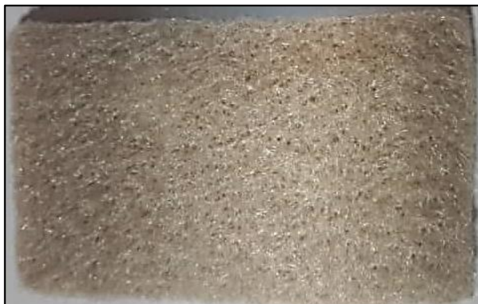
شکل ۷- پلیمریزاسیون شیمیایی الیاف ژئوتکستایل با پلیمر پیرول و اکسیدان هیدروژن پراکسید
