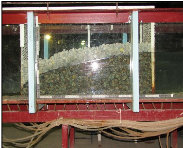
شکل ۳- عکس دیواره کناری فلوم برای تعیین عمق جریان عبوری از داخل محیط متخلخل
