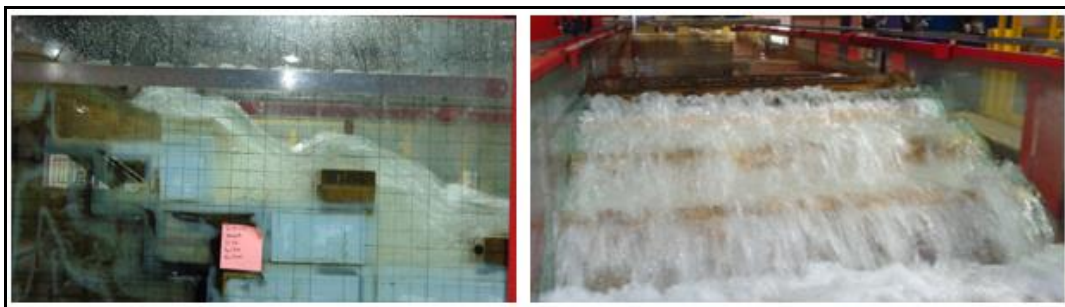
شکل ۱۳- نمای روبه‌رو و نیمرخ سرریز پلکانی-کنگره‌ای S3H7b'1
