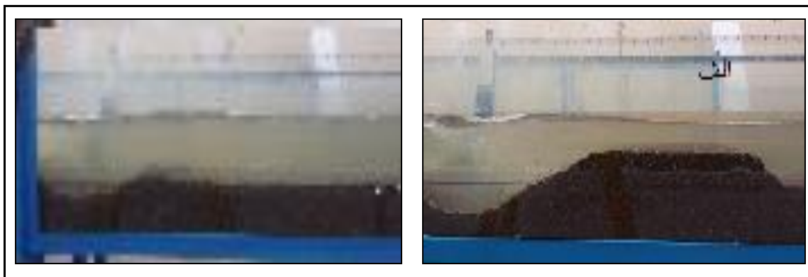
شکل ۸- نیمرخ آبشستگی الف) شیب کف حوضچه آرامش ۰/۰۲ و ب) شیب کف حوضچه آرامش ۰/۰۲-.
