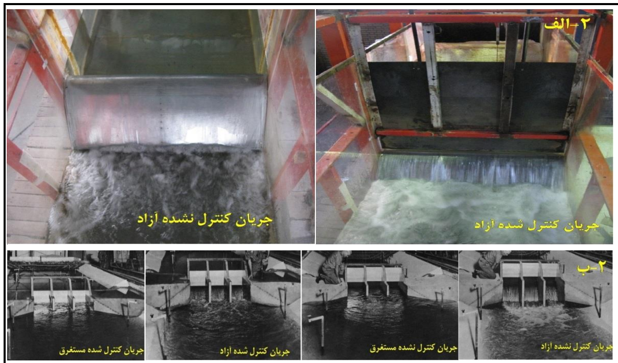
شکل ۲- حالات‌های مختلف جریان. الف) مدل آزمایشگاهی تحقیق حاضر و ب) مدل سرریز دریاچه‌دار آرکانزاس Fig. 2- Different flow states a) laboratory model of this study and b) Arkansas sluice-gated spillway model
