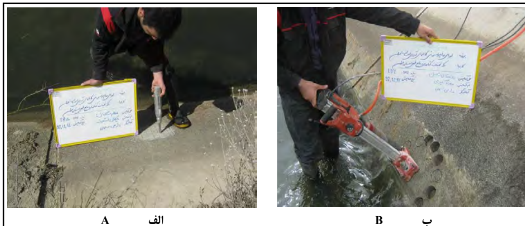
شکل ۴- الف) آزمایش چکش بازگشتی اشمیت و ب) مغزه‌گیریدر کانال قلعه‌قباد در شبکه نهر شعبان
