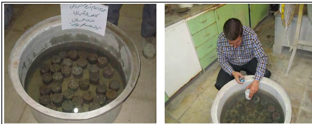
شکل ۵- آزمایش جذب آب مغزه‌های بتنی Fig. 5- Concrete cores water absorption test
