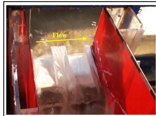
شکل ۶- نمونه سرریز با بال ۳۰ سانتی متر و پایه ۱۰ سانتی متر
