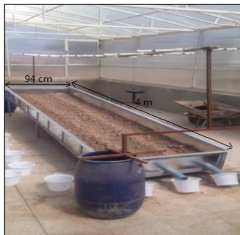
شکل ۲- نمایی از فلوم فرسایشی و دستگاه شبیه‌ساز باران مورد استفاده در پژوهش
