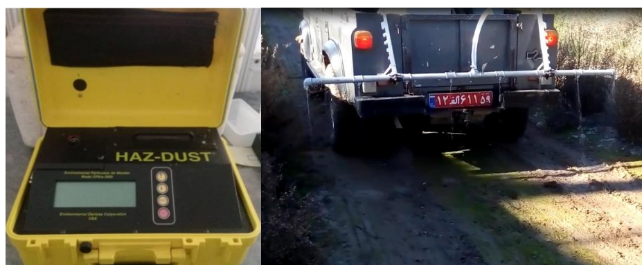
شکل ۳- (الف) سیستم اسپری محلول های ضد غبار و (ب) دستگاه غبار سنج مدل HAZ-DUST EPAM-5000
