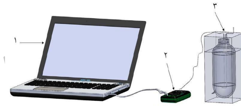
شکل ۲: سیستم اندازه‌گیری گرمای ویژه: ۱- لپ تاپ، ۲- دیتالاگر، ۳- کالریمتر
