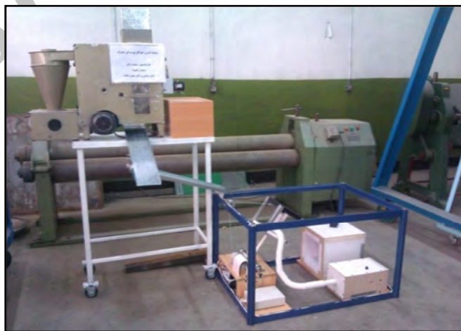
شکل ۱- مجموعه، کامل دستگاه پوست‌کن و سامانه کنترل خودکار
