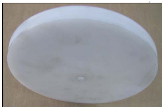
شکل ۵- پولی واحد ریسنده ماشین ساخته شده در این پژوهش
