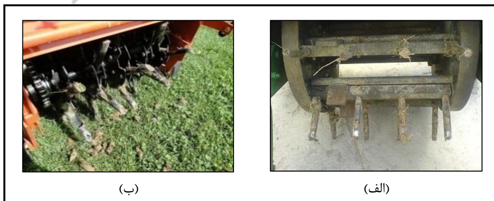
شکل ۴- (الف) ماشین هواده با انگشتی استوانه‌ای و (ب) ماشین هواده با انگشتی مخروطی
