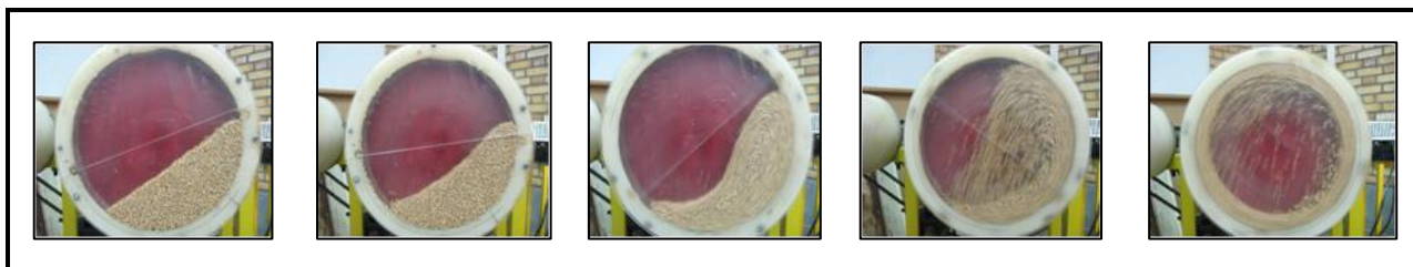
شکل ۸- حالت‌های مختلف حرکتی بذر گوجه‌فرنگی در استوانه دوار
