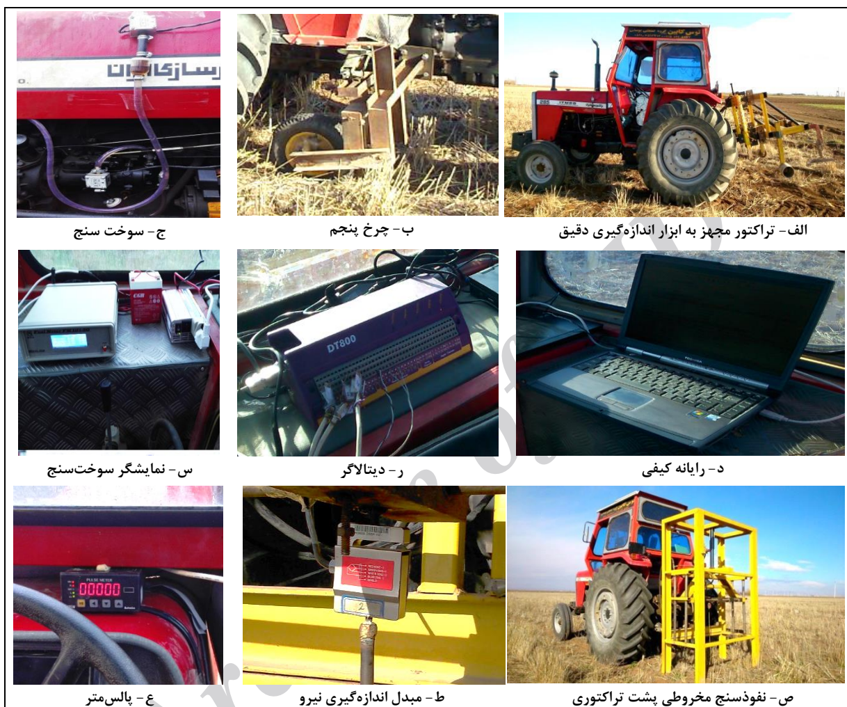
شکل ۲- تراکتور مورد استفاده در عملیات خاک‌ورزی و ابزارهای اندازه‌گیری نصب شده روی آن
