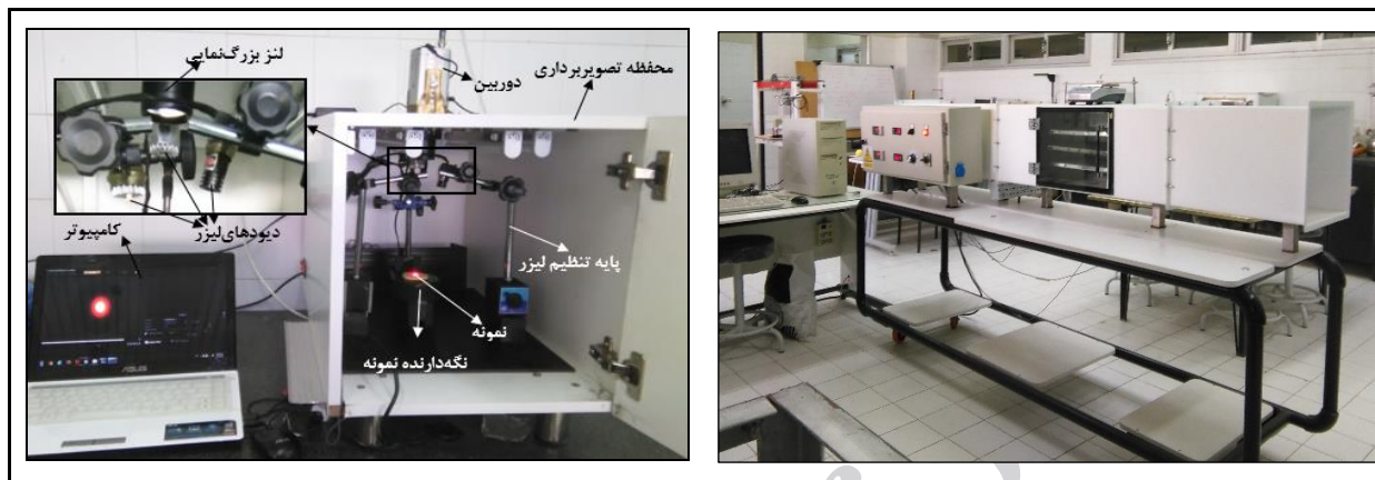
شکل ۱ - تصوير خشک کن مورد استفاده (تصوير سمت راست) و سامانه تصوير برداري پس پراکنش ليزر (تصوير سمت چپ)
