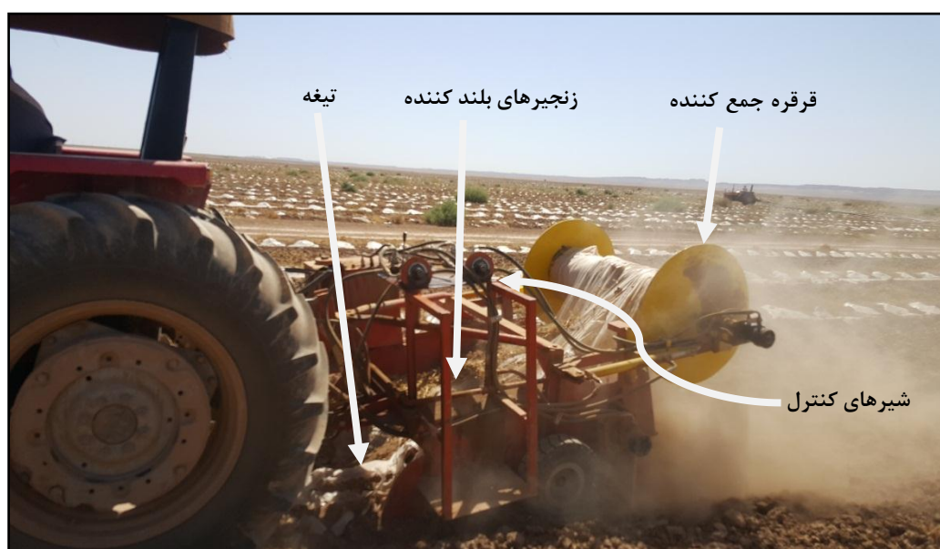
شکل ۱- نمایی از دستگاه پلاستیک جمع‌کن در حین کار، تیغه و زنجیرهای بلندکننده و شیرهای کنترل سرعت
