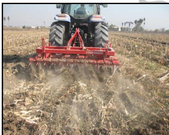
شکل ۱- ماشین ترا دیسک در حال تهیه زمین در بقایای ذرت
