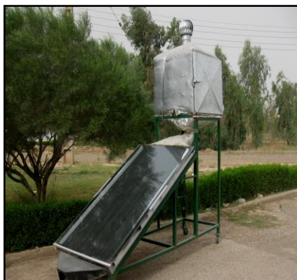
شکل ۲- صفحه جذب شیاردار ساده (A)
