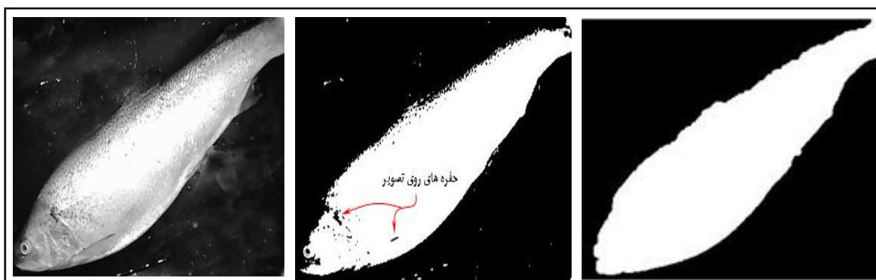
شکل ۵- سمت چپ: نمایش اولیه تصویر، وسط: حفره‌های روی تصویر سمت راست: تصویر اصلی با حفره‌های پر شده و رفع ناهمواری‌های روی مرز
