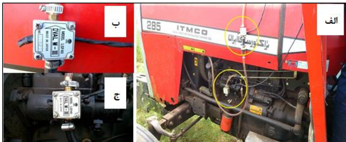
شکل ۳- حسگرهای سنجش جریان برای اندازه‌گیری مصرف سوخت (الف) نمای کلی (ب) حسگر در مسیر برگشت (ج) حسگر در مسیر رفت
