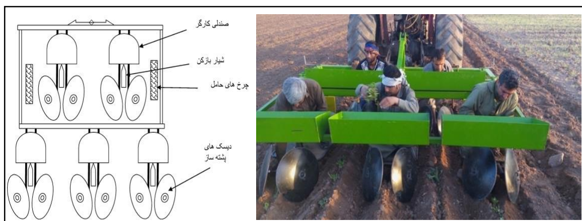
شکل ۳- نشاکار بدون سامانه انتقال نشا با پشته‌سازهای دیسکی Fig. 3- Transplanter with double disk ridgers and no planting unit
