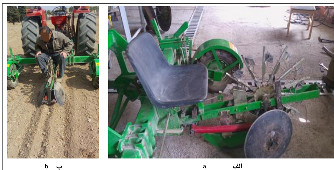
شکل ۱ - الف) نشاکار انبرکی با سامانه انتقال چرخ انگشتی و ب) جایگزین کردن چرخ‌های فشار با دیسک‌های پشته‌ساز Fig. 1- a) Transplanter with rotary gripper planting unit and b) press wheels replaced with double disk ridger
