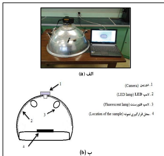
شکل ۱- الف) محفظه نورپردازی و ب) شماتیکی از محفظه نورپردازی و موقعیت قرارگیری لامپ‌ها در آن
